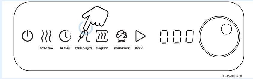
8. **Поверните** регулятор, чтобы настроить температуру томления с термощупом.
