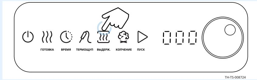
8. **Поверните** регулятор, чтобы настроить температуру томления.
